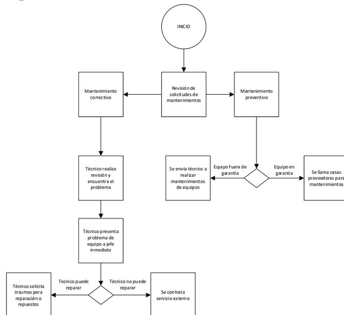
Ilustración 1 Diagrama de mantenimientos
